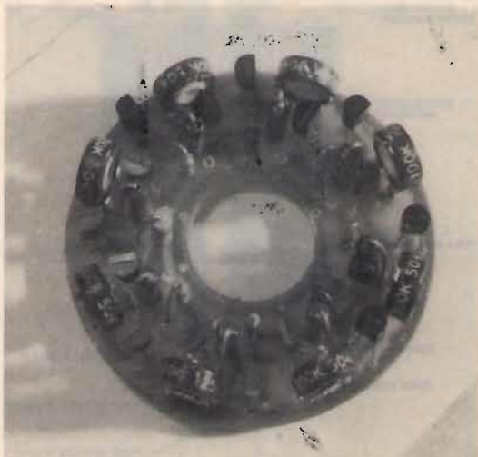
Il circuito dell'interruttore "esclusivo" a montaggio ultimato.
