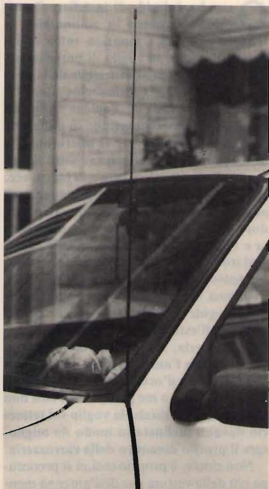
foto 2 10 in estetica: sembra quasi germogliata da una fessura della carrozzeria come parte integrante dell'autovettura, senza infamia e senza lode se l'antenna in esame fosse un'antenna trasmittente-ricevente, grazie al cielo è solo ricevente, per autoradio AM e FM, altrimenti il ROS sarebbe stato difficilmente correggibile.
