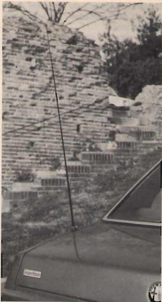
foto 6 Valida solo se per autoradio, sconsigliabile in altri casi. Il montaggio troppo in fiancata può essere pericoloso per le sporgenze ed eventuali oscillazioni di molte antenne flessibili e pesanti, sconsigliato pertanto.
