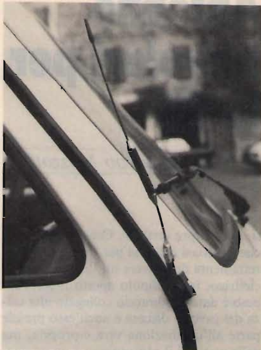
foto 1 Il peggior montaggio in senso assoluto: l'antenna in banda 27 MHz (CB) è all'apoteosi dell'inefficienza, esageratamente accorciata, troppo vicina alla fiancata metallica, l'unico vantaggio è che, date le sue microscopiche dimensioni, non si vede quasi, di conseguenza il tutto a solo ed esclusivo beneficio dell'estetica.
