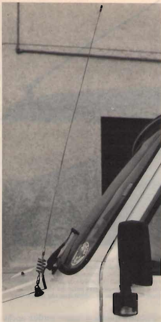
foto 7 Elettricamente parlando, ci troviamo abbastanza vicini al montaggio della foto 2, peccato non sia così bella! Anche qui l'eccessiva vicinanza al fianco parabrezza non giova molto all'irradiazione.
